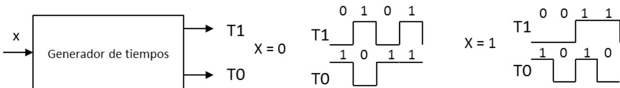
El sistema generará señales completas, de manera que sólo se tendrá en cuenta el valor de la entrada  $x$  cuando finaliza la generación de una señal. Inicialmente el sistema generará la señal correspondiente para  $x=0$ .
