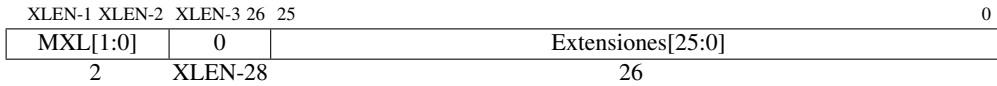
Figura 10.21: El CSR de ISA de Máquina mis a reporta el ISA soportado. El campo MXL (XLEN de Máquina) codifica el ancho del ISA base nativo de enteros: 1 es 32 bits, 2 es 64, y 3 es 128. El campo Extensiones codifica la presencia de las extensiones estándar, con un único bit por letra del alfabeto (el bit 0 codifica la presencia de la extensión “A”, el bit 1 codifica la presencia de la extensión “B”, hasta llegar al bit 25 que codifica “Z”).
