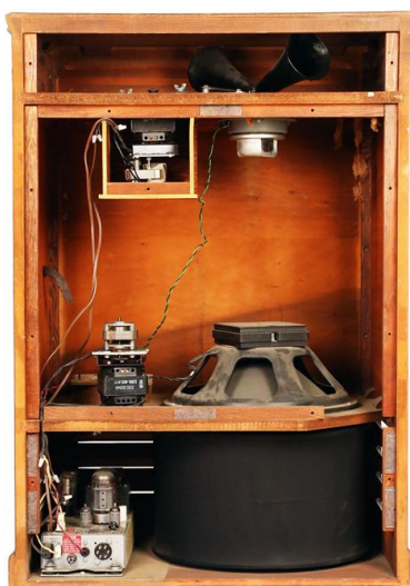
Figura 2.8: Altavoz rotatorio Leslie . En la parte superior hay dos bocinas ( tweeters ), en la inferior un subwoofer para los graves. Ambos giran.
