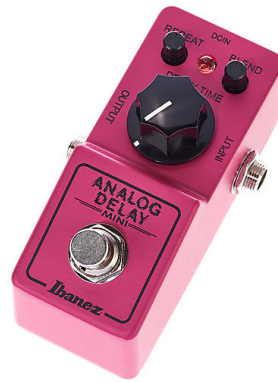
Figura 2.6: Pedal de delay . El pulsador lo activa o desactiva, con el potenciómetro se ajusta la duración.
