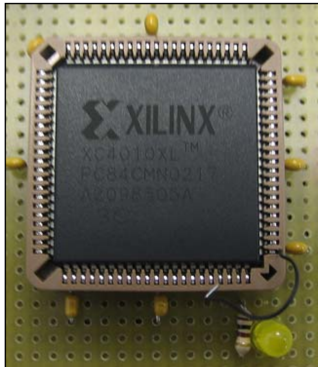
Figura 41: FPGA XC4010XL-PC84CMN0217 con un LED en el pin 51
