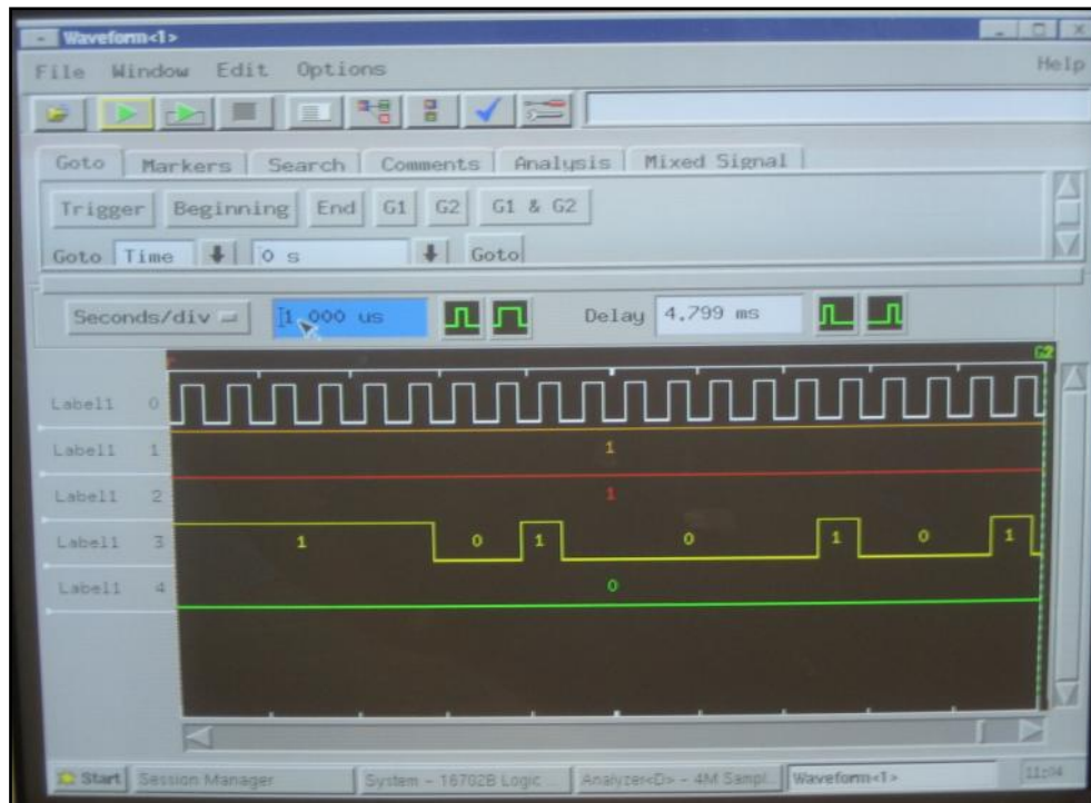
Figura 32: Analizador lógico durante el envío del bitstream
