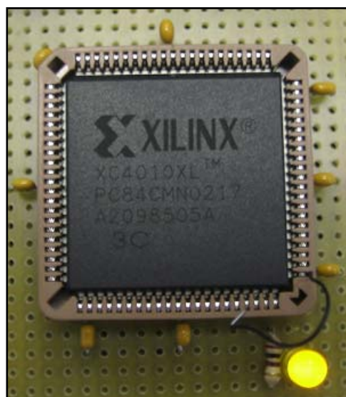
Figura 44: El LED encendido después de la programación de la FPGA
