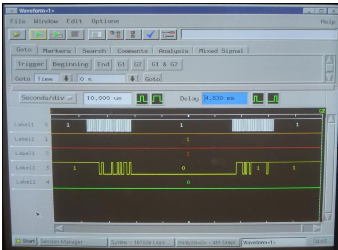
Figura 29: Envío de 128 bytes a través del chip USB
