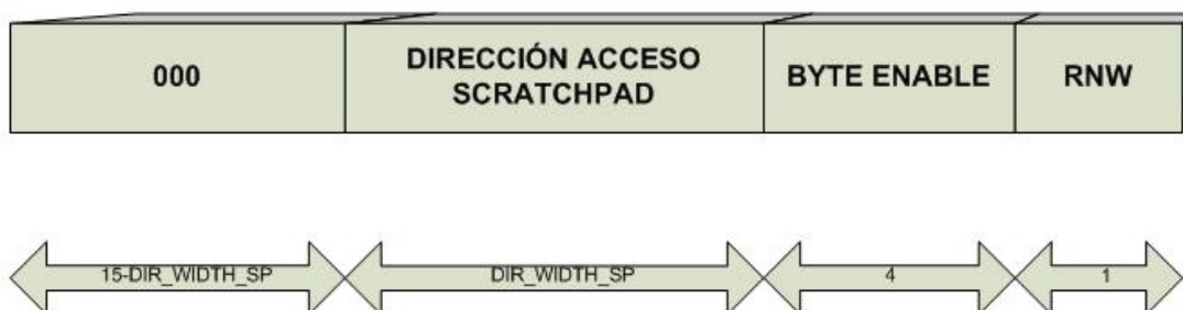
Figura nº41: Formato del S2M_BusData para el sniffer de la scratchpad
