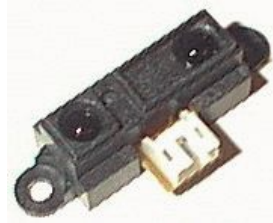
Figura 34 Sensor de infrarrojos GP2D12
