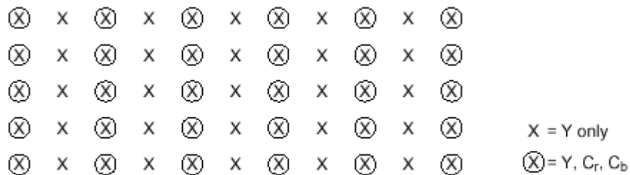
Figura 15. Estructura de muestreo 4:2:2.
