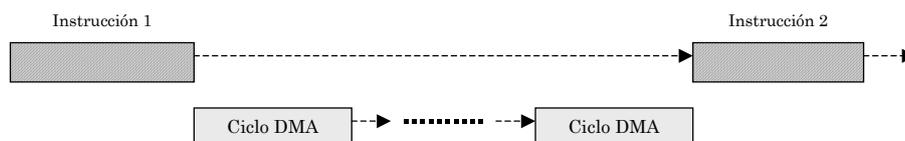
**Robo de ciclos:** el DMA toma control del bus y lo retiene durante un solo ciclo. Transmite una palabra y libera el bus. Es la forma más usual de transferencia y en ella se dice que el DMA roba ciclos a la CPU.
