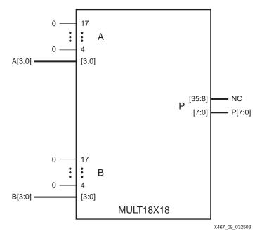
Figure 11: MULT4X4\_U Submodule
