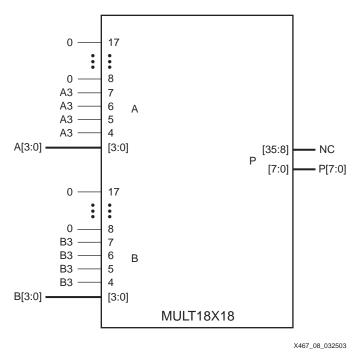
Figure 10: MULT4X4\_S Submodule
