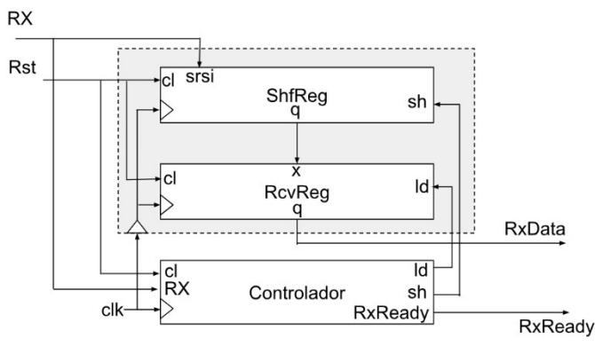
Este receptor está formado por un registro de desplazamiento a la derecha (ShfReg), por un registro con carga (RcvReg) y por un controlador que gestiona la transmisión. Durante la transmisión, los bits irán llegando uno a uno por la línea RX, y se irán almacenando en ShfReg mediante un desplazamiento a la derecha. Una vez que hayan llegado todos a ShfRef, se cargan conjuntamente en el registro RcvReg, desde donde pueden ser leídos en paralelo por la línea RxData.
