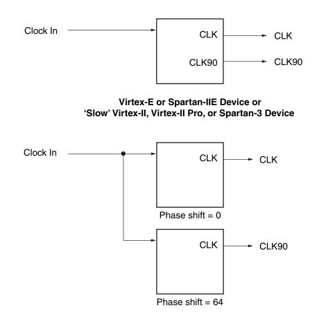
'Fast' Virtex-II, Virtex-II Pro, or Spartan-3 Device
